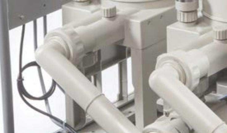
Les appareils de la gamme MINIPURE éliminent en continu tous les microcopeaux, fines, particules solides et huiles entières surnageantes ou en émulsion provenant de la lubrification de la machine (cas des huiles solubles). Convient également pour l'électro-érosion, la découpe jet d'eau...
