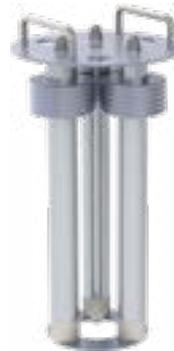
**Le liquide à filtrer est canalisé autour de barreaux magnétiques en inox de 300mm qui captent les particules métalliques.**
