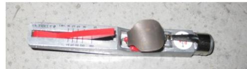
Déterminer la tension des courroies grâce aux diamètres des poulies et contrôler à l'aide de l'appareil de mesure de tension type OPTIKRIK 0, I, II ou III (ci-contre).
