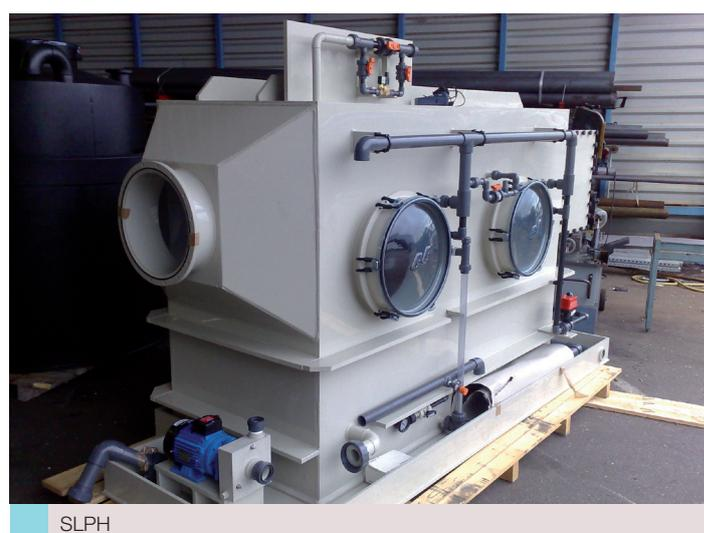
Dans le cadre du traitement de surfaces métalliques, les laveurs SLPH sont adaptés et performants pour les composés suivants :
